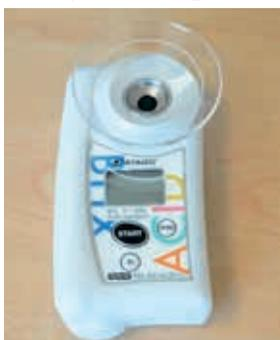
L'outil indique la teneur en sucres en % Brix (par réfractométrie) à partir du jus directement prélevé sur l'échantillon. Pour la mesure de l'acidité une dilution du jus par 50 avec de l'eau déminéralisée doit être faite avant une mesure sur la même cellule (par conductimétrie).
