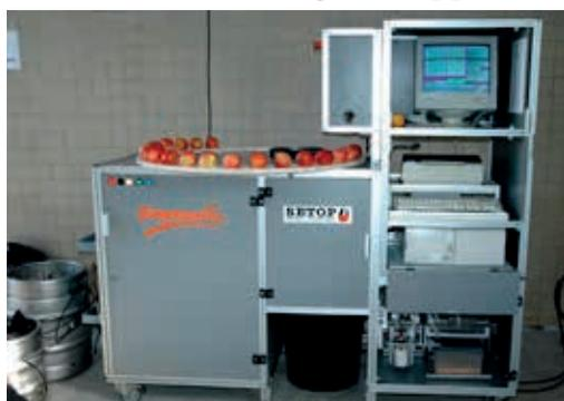
Les appareils sont livrés étalonnés. L'appareil réalise un autocontrôle à chaque cycle de mesures. Un nettoyage complet et minutieux de l'appareil doit
